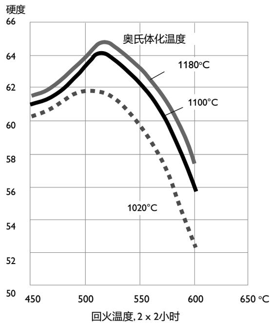
回火曲线基于15 x 15 x 40 mm的样品热处理并强制气冷后的数据。由于实际工具尺寸及热处理参数等差异经热处理后，工模具的硬度可能会下降。
