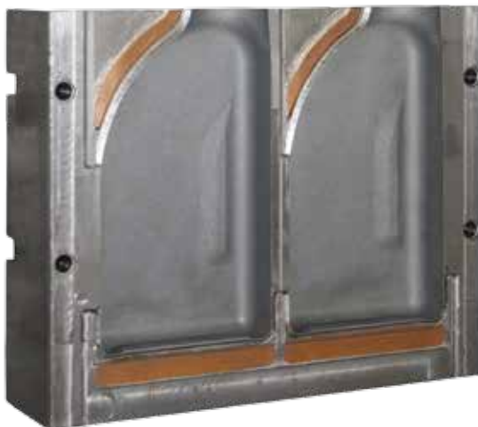
用于挤压吹塑成型的ASSAB MM40 嵌件。
